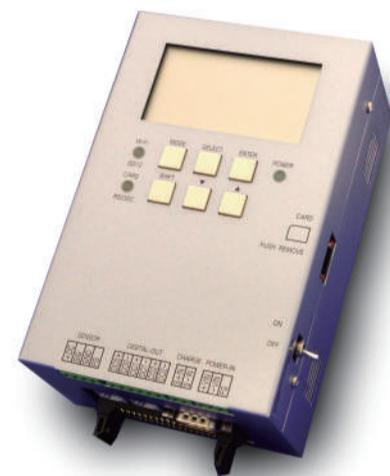
[MODEL2310-04 センサーコントローラ / データロガー]
